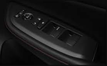
Door Switch Panel
